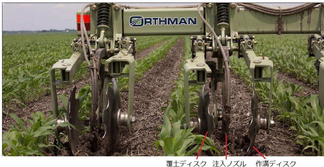
図 4. 液体肥料専用施肥機の肥料注入部
